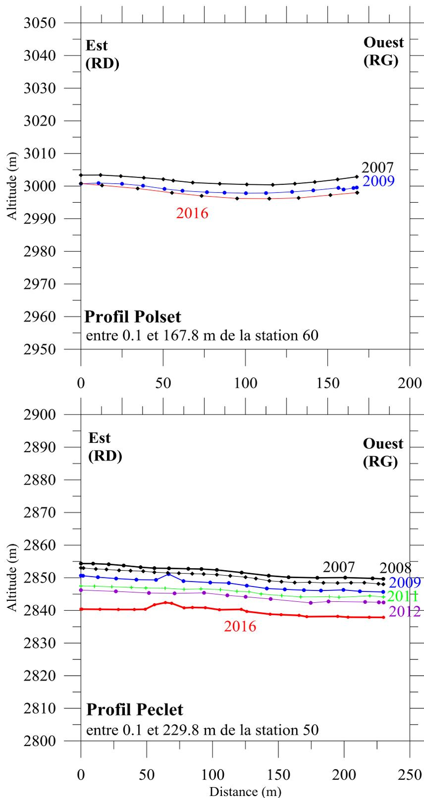
Figure 5a : Variations d'altitude aux profils Polset (3000 m d'altitude) et Pecllet (2850 m d'altitude). La situation de ces profils est reportée sur la figure 1. RD et RG signifient Rive Droite et Rive Gauche.
