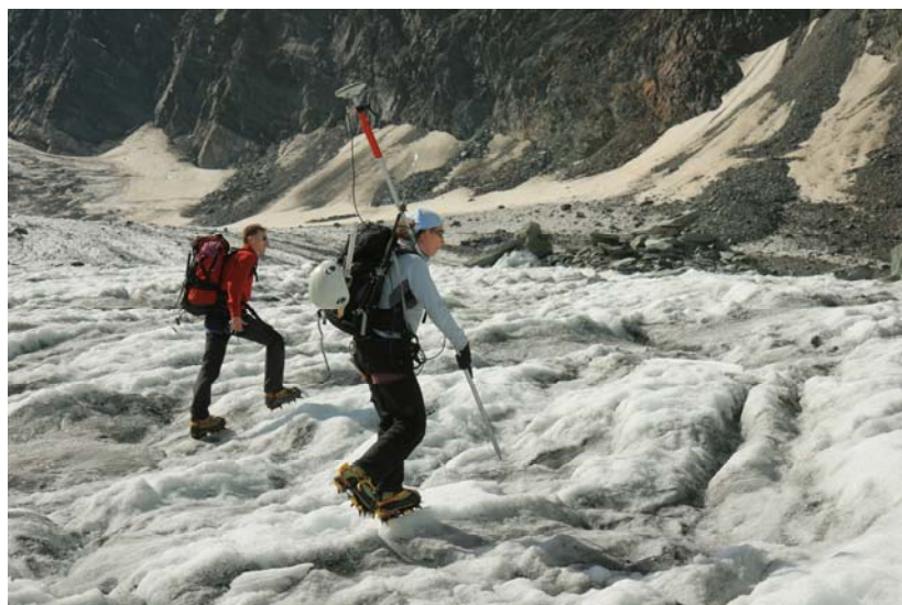
Figure 2 : relevé de la topographie du réseau de balises dans la zone d'ablation de Gébroulaz en Août 2008. Ces mesures sont réalisées à l'aide d'un GPS différentiel LEICA dont on voit ici l'antenne montée sur une canne. Photo : B. Jourdain
