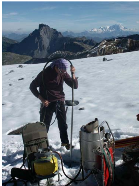
Figure 2 : renouvellement du réseau de balises dans la zone d'ablation de Gébroulaz en Août 2007. Le relevé des émergences de ces balises permet d'obtenir les bilans de masse du glacier, c'est-à-dire une information sur les variations de volume du glacier. Photo : C. Vincent
